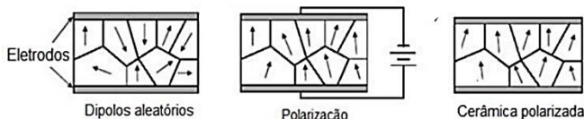
Figura 3 – Esquema de uma cerâmica ferroelétrica, não polarizada, no processo de polarização e polarizada.
