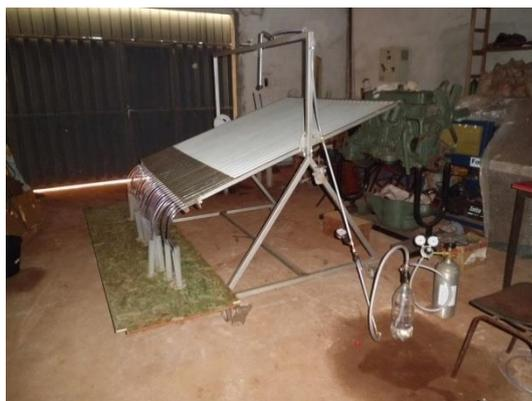
FIGURA 1. Mesa de teste para bicos de pulverização hidráulica.
