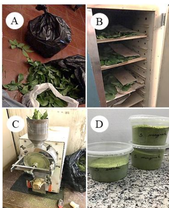
Figura 2. A) Folhas expandidas de Serjania spp. recém coletadas; B) Folhas de Serjania spp. colocadas em câmara de circulação forçada de ar a 40 °C ( \pm 1 °C) (3 dias); C) Folhas de Serjania spp. sendo trituradas em moinho industrial; D) Pó fino de S. erecta e S. marginata para o preparo dos extratos aquosos. (Créditos: Eduardo Carvalho Faca).
