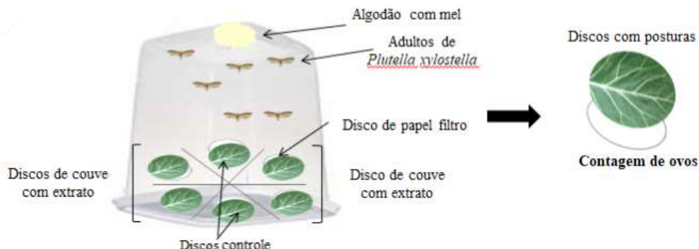
Figura 3. Representação esquemática do bioensaio de oviposição com múltipla escolha.
