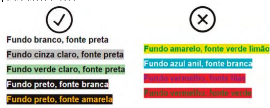
Figura 15 – Exemplos de relações de contraste efetivas e pouco efetivas para a acessibilidade.
