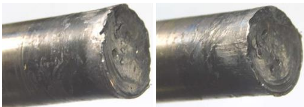
FIGURA 9 – Análise Fratográfica visual do ângulo de quebra (Foto Autoral)
