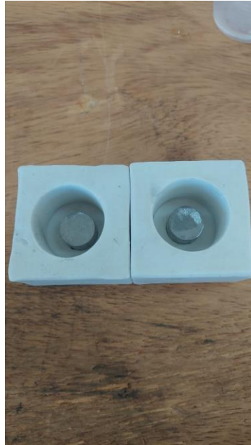
Figura 15 – Embutimento das Amostras do Grupo A em molde de silicone.
