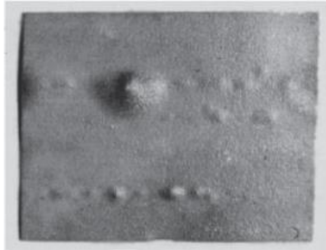
Figura 10: Corrosão empolamento por hidrogênio
