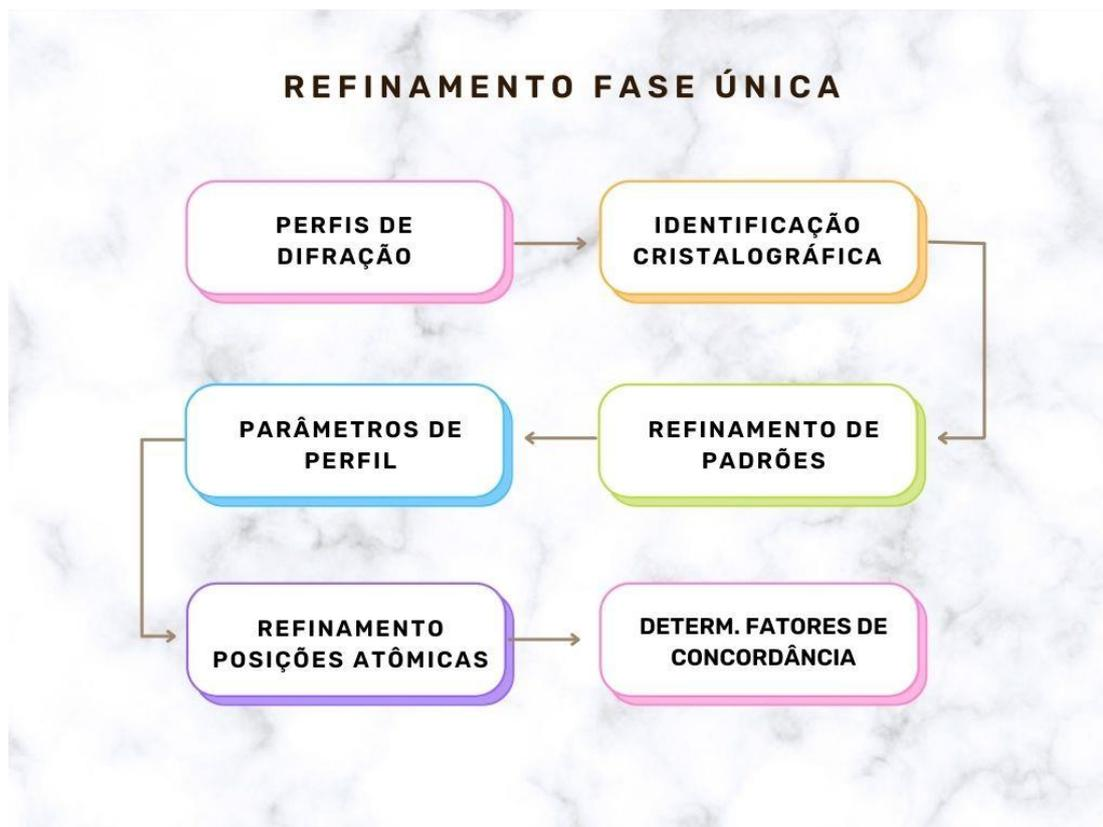
Figura 13. Esquema dos procedimentos experimentais adotados no refinamento estrutural de fase única das cerâmicas de PLZT. (Fonte própria).
