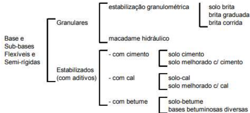
Figura 3 – Classificação das bases e sub-bases flexíveis e semirrígidas para pavimentação.
