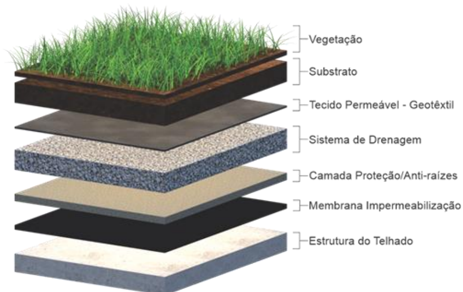
Figura 2 – Camadas que compõem o telhado verde
