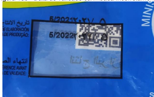
Figura 13b - Data de validade carimbada incorretamente
