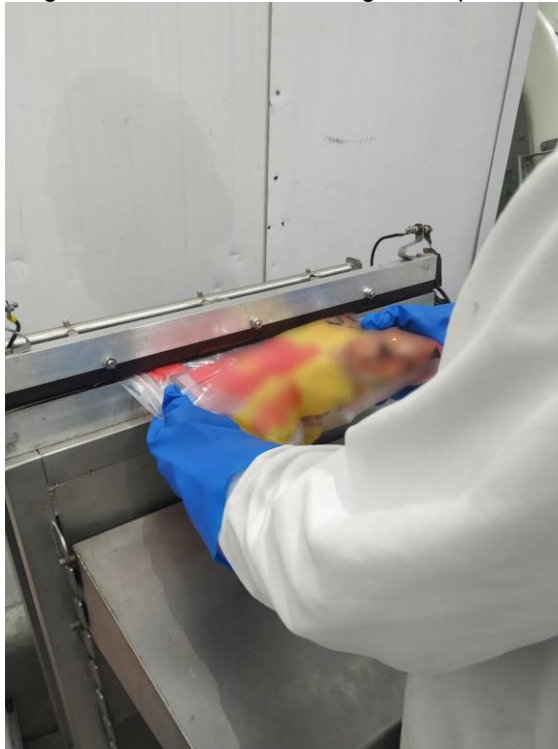
Figura 26 - Processo de selagem de pacotes
