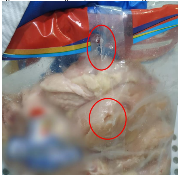
Figura 17 - Embalagem queimada na selagem vertical
