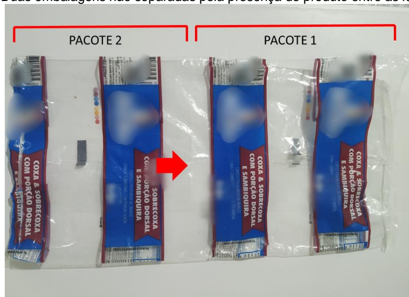
Figura 20 - Duas embalagens não separadas pela presença de produto entre as facas de corte
