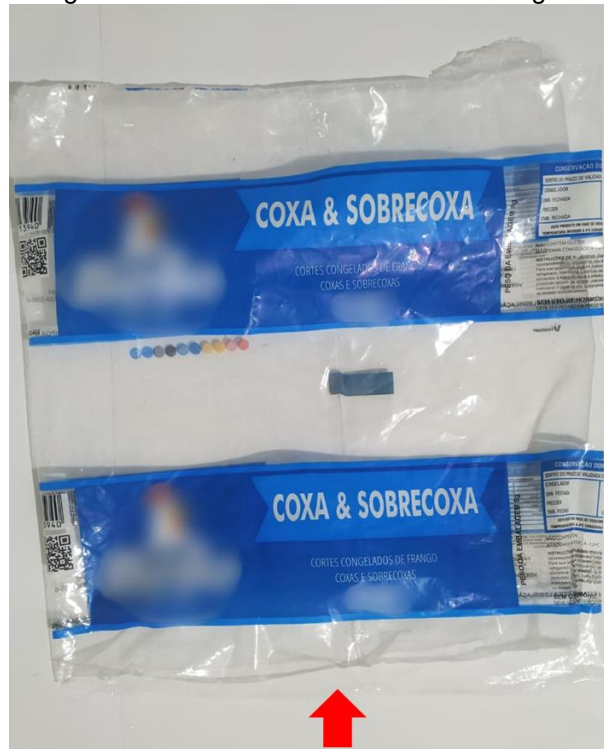
Figura 19 - abertura horizontal na embalagem
