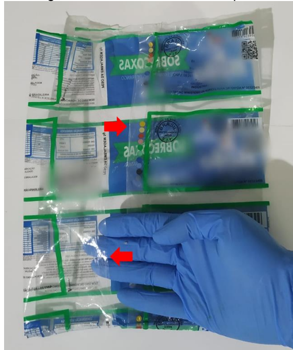
Figura 16 - embalagem não selada verticalmente por não estar alinhada
