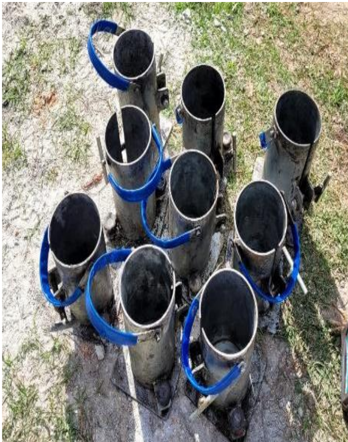
Figura 3 – Moldes utilizados na realização do ensaio de resistência a compressão.
