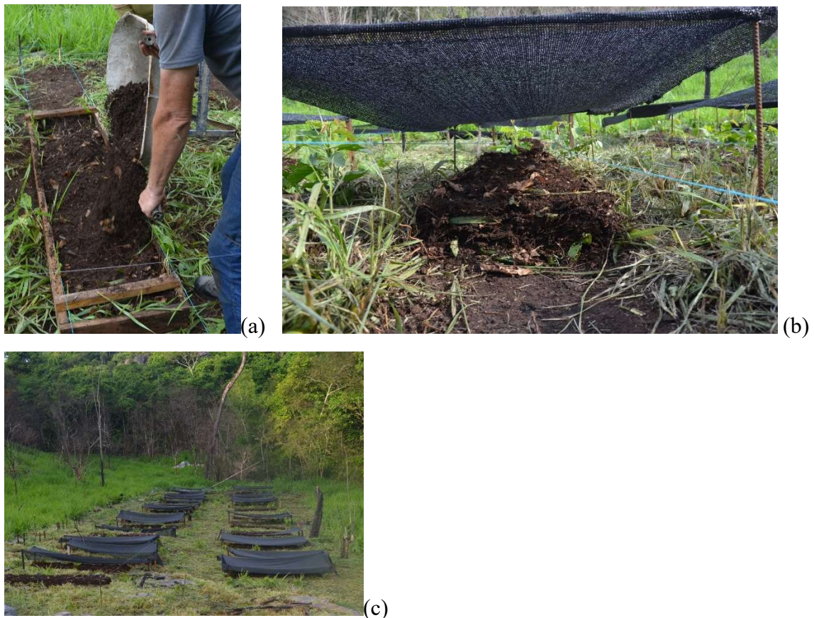
Figura 2. Ilustração de etapas do experimento: a) inclusão do topsoil homogeneizado no gabarito de madeira; b) topsoil depositado no canteiro sob tela de sombreamento suspensa; c) visão geral do bloco experimental instalado na base do morro.
