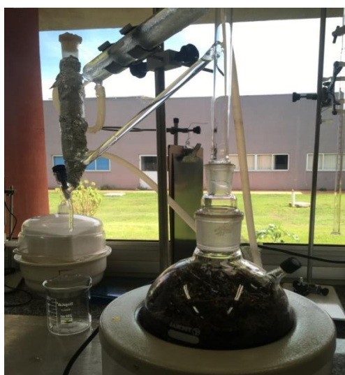
Figura 2 – Processo de extração de óleo essencial por Clevenger. FONTE: Autor
