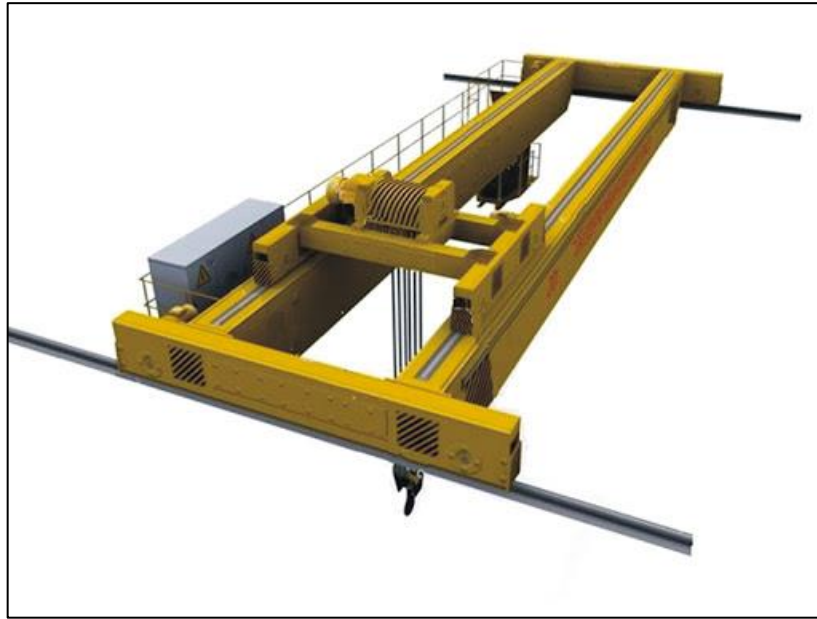
Figura 5: Ponte Rolante apoiada dupla-viga.
