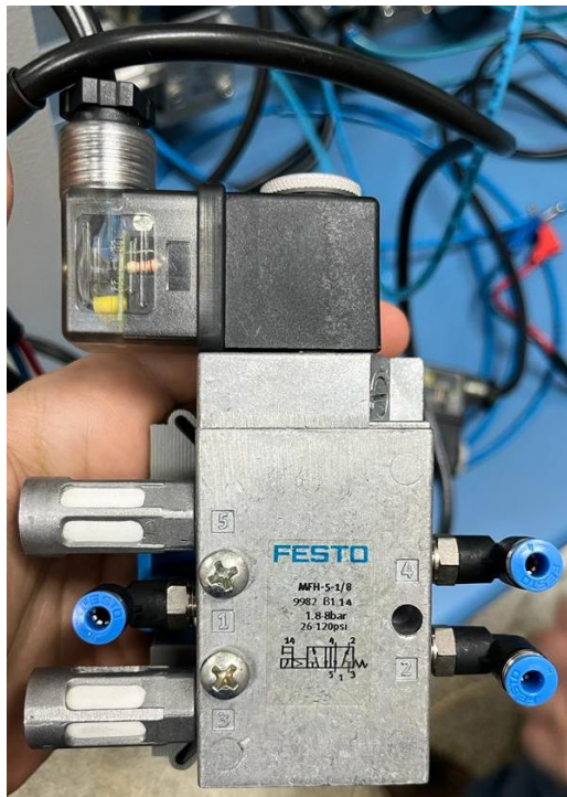
Figura 43 - Válvula 5/2 com acionamento por solenoide e retorno por mola.
