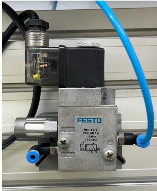
Figura 42 - Válvula 3/2 com acionamento por solenoide e retorno por mola.
