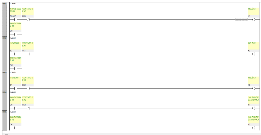
Diagrama 4 - Diagrama Ladder para 1 pistão de avanço e retorno automático.
