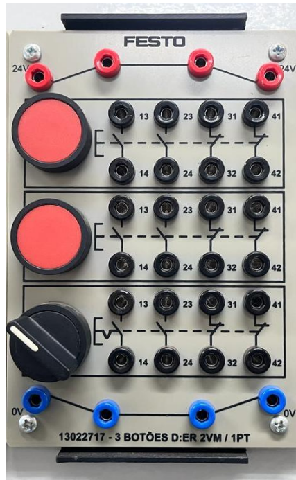
Figura 40 - Placa de botões de comando elétrico.
