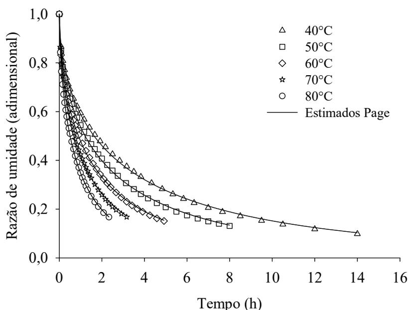
FIGURA 7. Valores de razão de umidade experimentais e estimados, pelo modelo de Page, para a secagem das sementes de feijão-caupi em camada delgada em diferentes temperaturas na velocidade do ar de secagem de  $1,6 \text{ m s}^{-1}$ .
