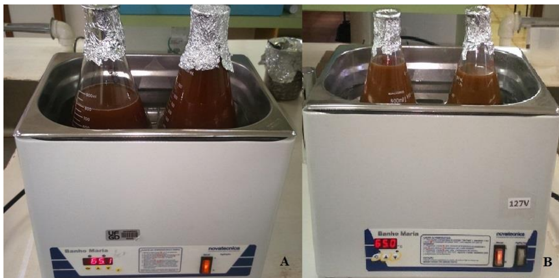
FIGURA 10. Detalhe do processo de esterilização dos extratos, banho-maria a 65°C durante 1 hora. A- Extrato aquoso de cravo-da-índia; B - Extrato aquoso de canela. Dourados - MS. 2015.
