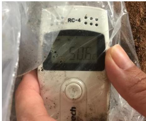
Figura 4 Dataloggers utilizados para monitorar a temperatura.
