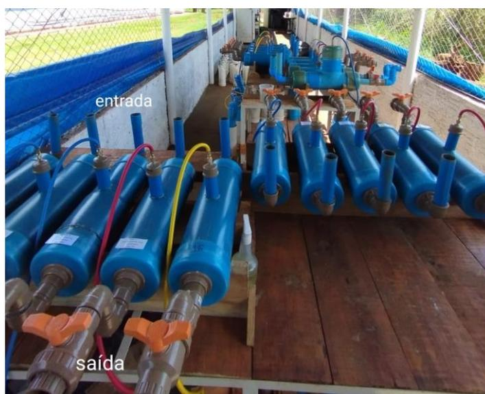
Figura 1: Bateria de biodigestores semi-contínuos, em escala experimental.
