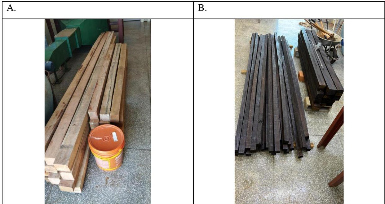
**Figura 8.** Vigas sem impermeabilização (A) e vigas impermeabilizadas após a aplicação de Novatrol (B).
