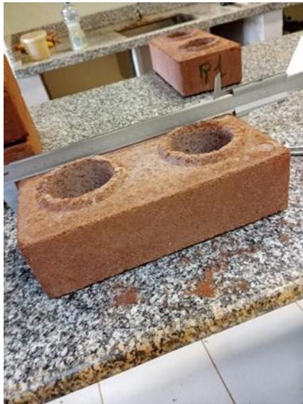
**Figura 5.** Medição do comprimento do corpo de prova utilizando o paquímetro.
