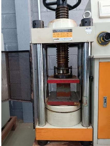
**Figura 8.** Rompimento de corpo de prova em prensa hidráulica.
