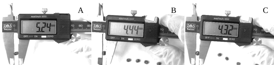
Figura 1. Ilustração da determinação das dimensões características do grão de feijão mungo. (A) comprimento, (B) largura e (C) espessura.
