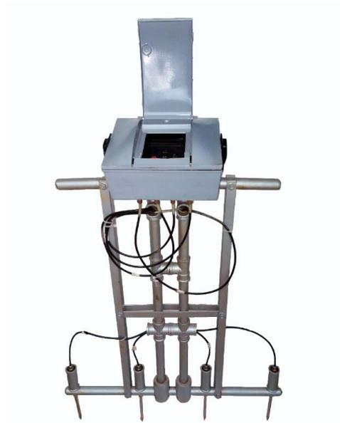
**Figura 5.** Vista frontal do MCEAS – Medidor de condutividade elétrica aparente do solo.
