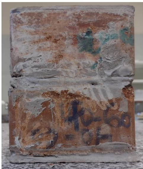
Figura 8. Corpo de prova preparado para o ensaio de resistência à compressão.
