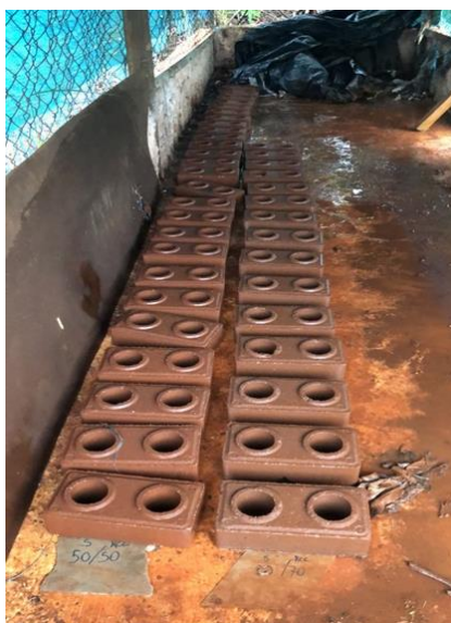
Figura 4. Tijolos de solo-cimento com adição de RCC durante o processo de cura.
