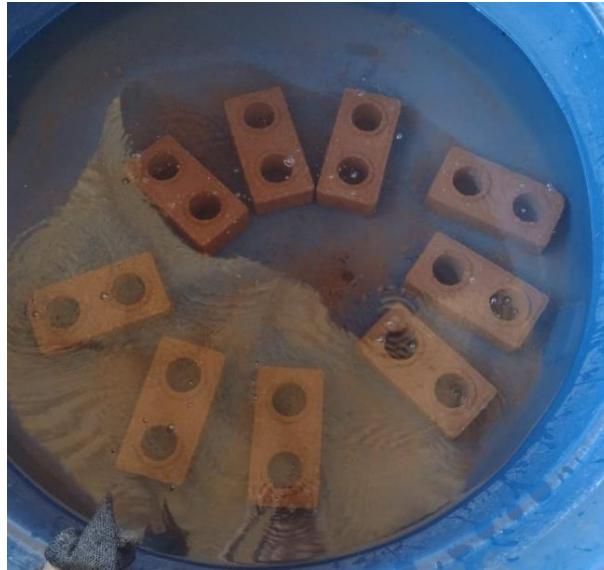
Figura 7. Corpos de prova imersos em tanque com água.
