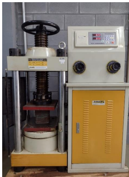
Figura 10. Corpo de prova na prensa elétrica digital durante o ensaio de resistência à compressão.
