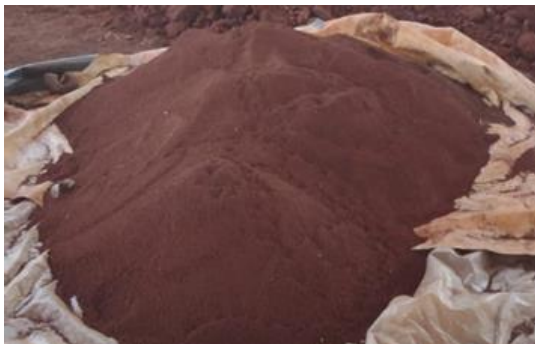
Figura 1. Solo (A) e RCC (B) passado na peneira com abertura de 4,75 mm.
