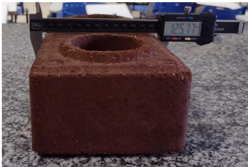
Figura 5. Tijolos sendo medidos para os ensaios de análise dimensional.
