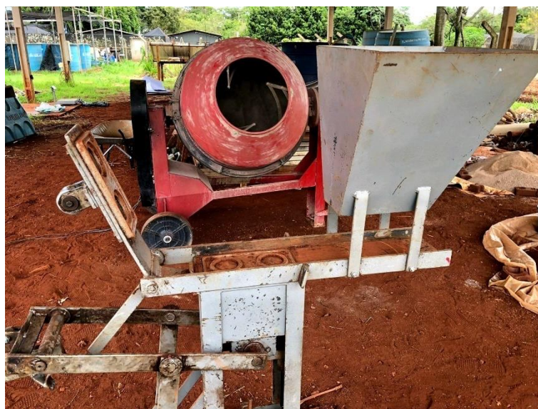
Figura 3. Prensa manual e betoneira de 400 L utilizados para fabricação dos tijolos de solo-cimento com adição de RCC.
