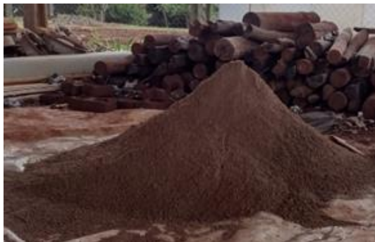
Figura 1. Solo (A) e RCC (B) passado na peneira com abertura de 4,75 mm.
