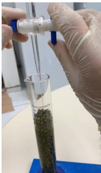
**Figura 2.** Preenchimento dos espaços vazios da proveta, com grãos, utilizando hexano.
