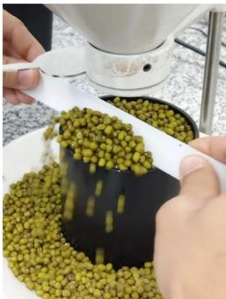
**Figura 1.** Aparato para determinação da massa específica de grãos, utilizado com o nivelamento da massa.
