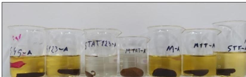
**Figura - 20.** Coloração do sobrenadante após 48 horas do filme em água destilada.
