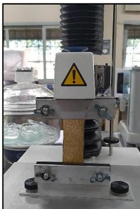
Figura – 6. Teste de resistência a tração e alongamento.
