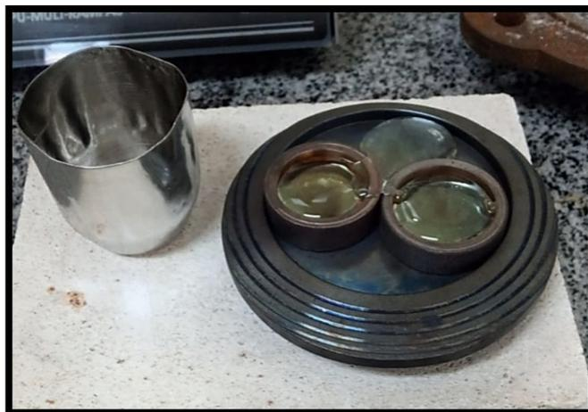
Figura 9. Amostras vítreas obtidas nos moldes de latão sobre base de aço inoxidável. Ao lado esquerdo, o cadinho de  $Pt_{0,95}/Au_{0,05}$  utilizado para a fusão.
