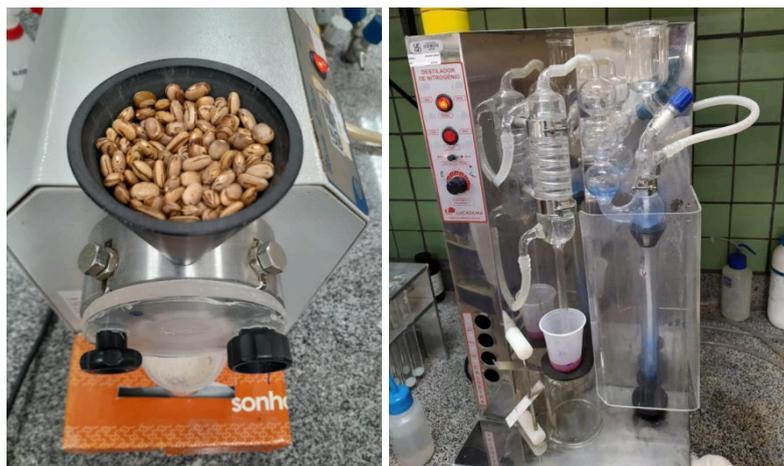
Figura 9 - Moagem dos grãos em moinho de facas para a análise de proteínas e destilador utilizado para a análise, respectivamente.
