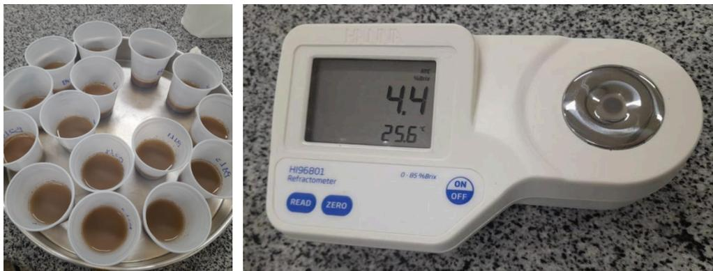
Figura 8 - Caldo obtido após o cozimento e avaliação de BRIX em refratômetro, respectivamente.
