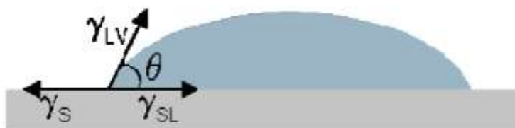
Figura 4. Ângulo de contato entre o líquido e a superfície. \gamma_S é a energia de superfície do sólido; \gamma_{LV} tensão superficial do líquido em equilíbrio com o vapor; e \gamma_{SL} é a energia da interface sólido-líquido. Fonte: (PEROVAL et al. , 2002).
