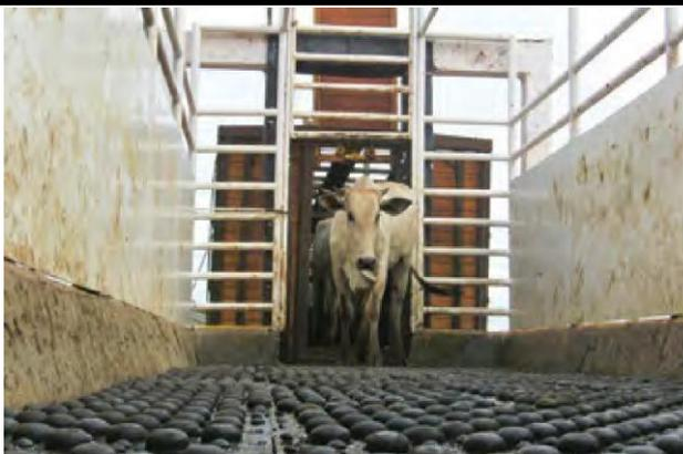
Desembarcadouro com paredes laterais fechadas e piso antiderrapante emborrachado em nível com o caminhão
