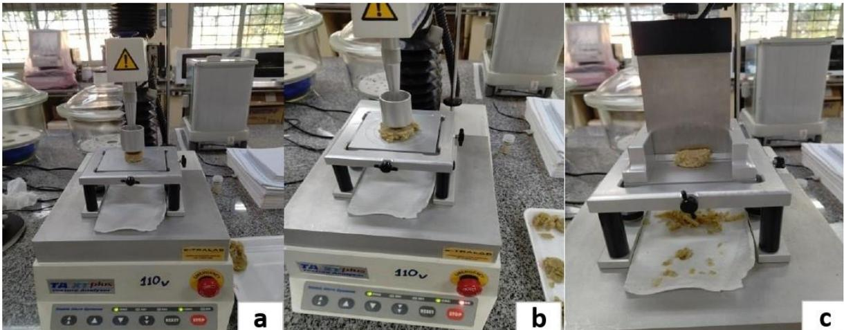
FIGURA 8. (a) amostra para análise do perfil de textura; (b) amostra pós o corte; (c) amostra para análise da força de cisalhamento.
