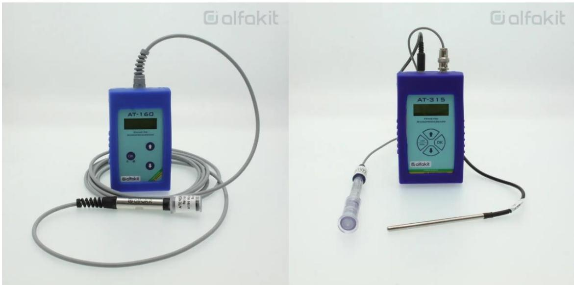
Figura 2 - Sondas AT-160 E AT-315 utilizadas durante o período experimental. Fonte: Alfakit.
