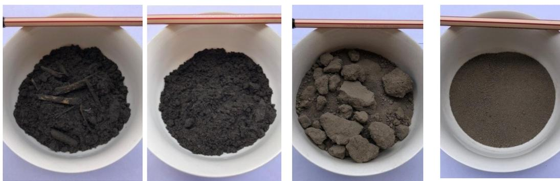
**Figura 2.** Cinzas utilizadas no estudo: a) CBC antes do peneiramento, b) CBC após peneiramento; c) CME antes do peneiramento; d) CME após peneiramento.
