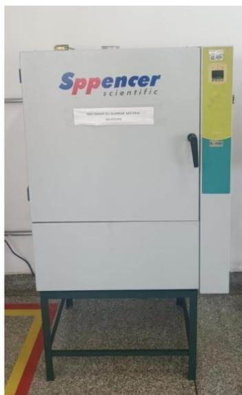
**Figura 6:** Estufa utilizada para retirar a umidade da biomassa.
