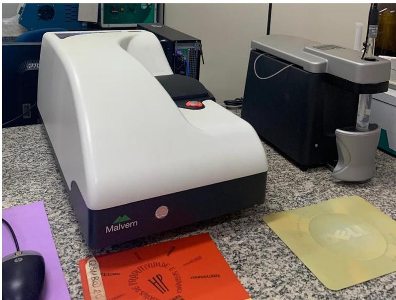
**Figura A6.** Equipamento de Espalhamento Dinâmico de Luz (EDL) utilizado para a determinação do Tamanho Hidrodinâmico (Dh) e do Índice de Polidispersidade (PDI) das micelas formadas nas nanoemulsões. Fonte: Autora.
