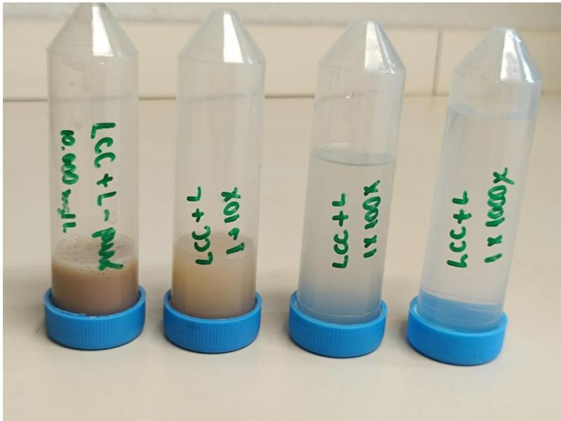
**Figura A5.** Amostras de LCCtL puro (10.000 mg/L) e diluídas em 10, 100 e 1000 × utilizadas para análises de tensão superficial, condutividade elétrica e potencial zeta. Fonte: Glenda Biasotto Porzani.
