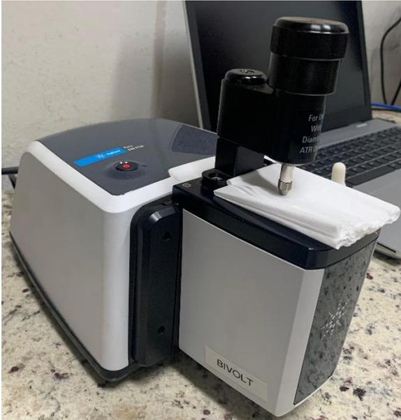
**Figura A9.** Equipamento de FTIR acoplado a acessório de refletância total atenuada (ATR), utilizado para análise de infravermelho das amostras. Fonte: Autora.
