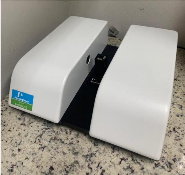
**Figura A7.** Espectrofotômetro UV-Vis utilizado para analisar o espectro de absorção do bioproduto LCCTL. Fonte: Autora.
