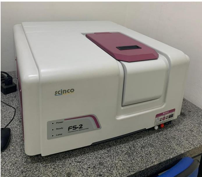
**Figura A8.** Fluorímetro utilizado para medir a intensidade de fluorescência do bioproduto LCCTL, permitindo a detecção e caracterização de compostos fluorescentes presentes na formulação. Fonte: Autora.
