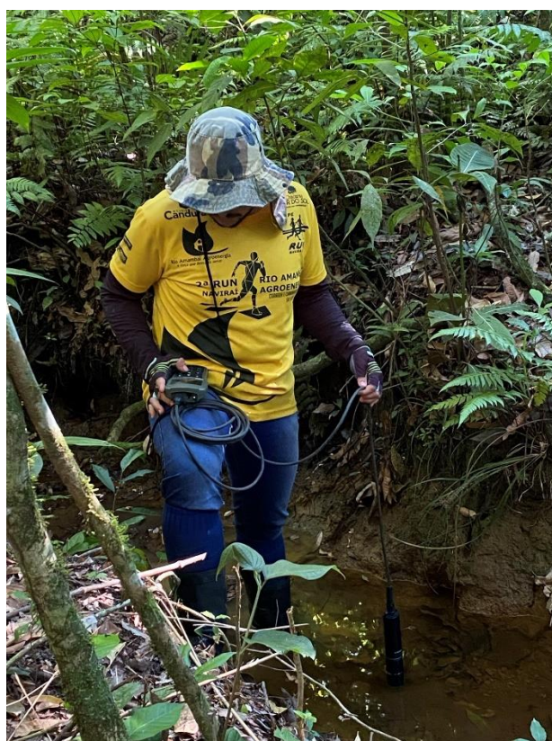
Figura S6. Medição dos parâmetros físico-químicos com sonda multiparâmetro.
