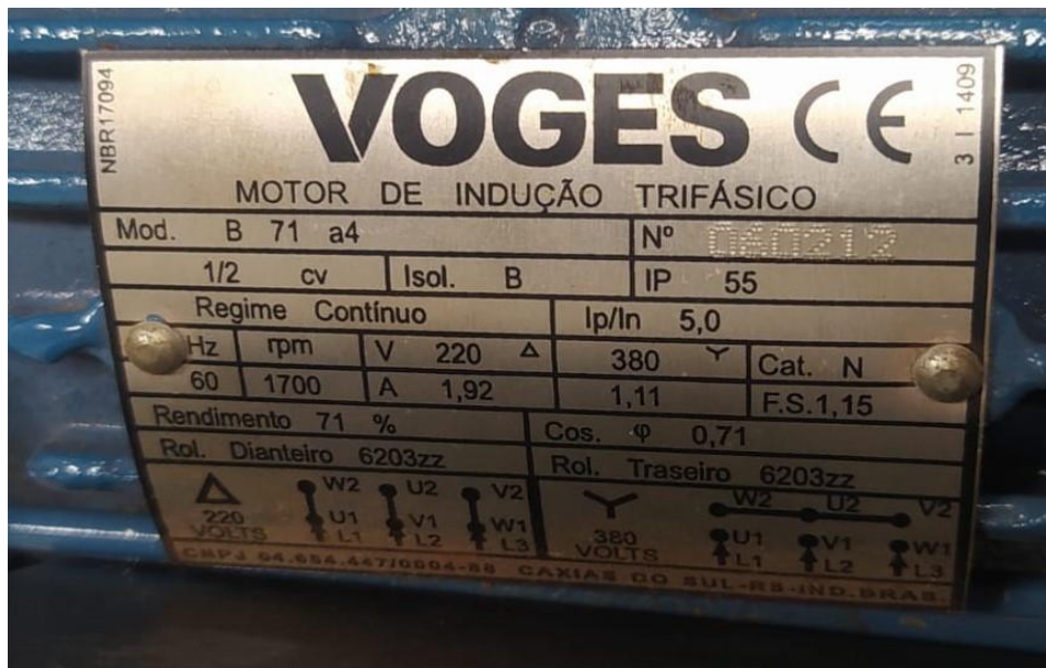
Figura 9 – Dados de Placa do Motor de Indução Trifásico (MIT).
