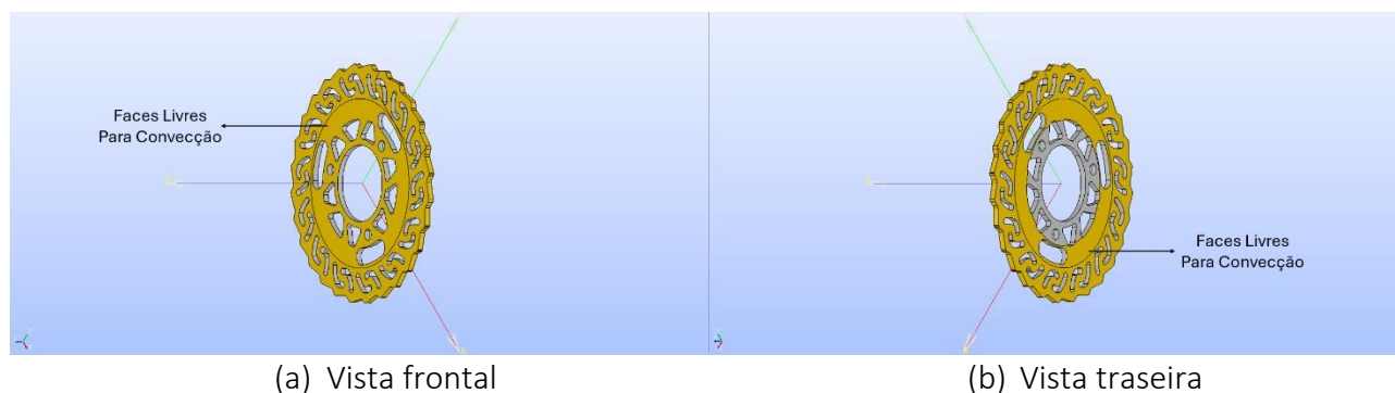
FIGURA 3: Grupos de aplicação de convecção (superfícies destacadas em laranja).
