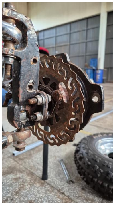
FIGURA 2: Montagem do disco de freio.
