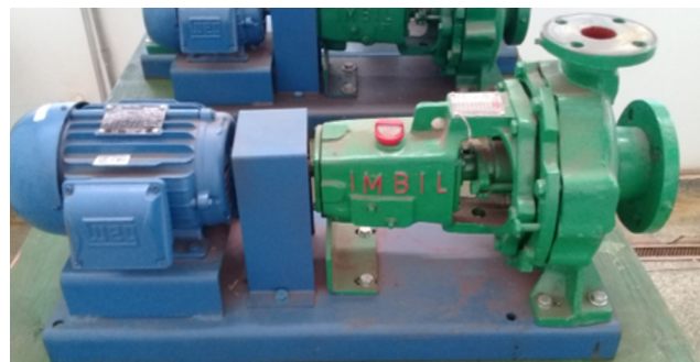
Figura 10 – BFT IMBIL® modelo INI 32200, com potência nominal de 2 cv.
