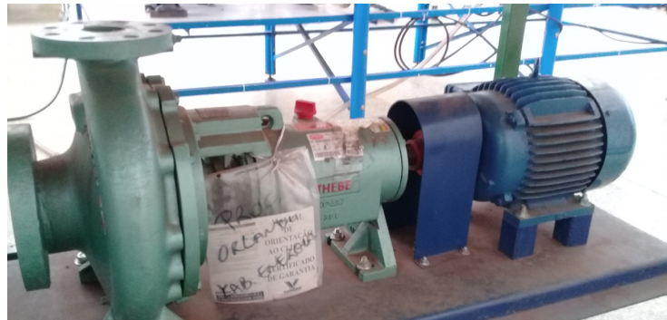
Figura 9 – BFB THEBE® modelo TH-50/250 MANCA, com potência nominal de 10 cv.
