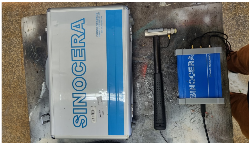
Figura 31 – Instrumentos utilizados na análise modal experimental: martelo instrumentado e acelerômetro triaxial.
