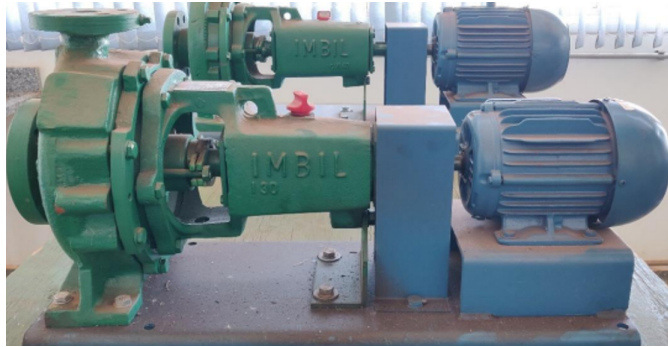
Figura 11 – BFT IMBIL® modelo INI 40200, com potência nominal de 4 cv.
