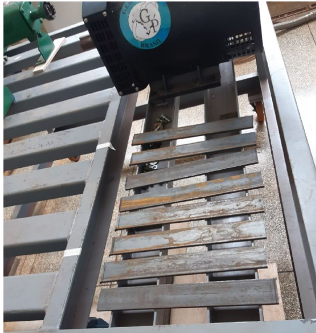
Figura 19 – Chapas metálicas utilizadas na construção do sistema de deslocamento do alternador.
