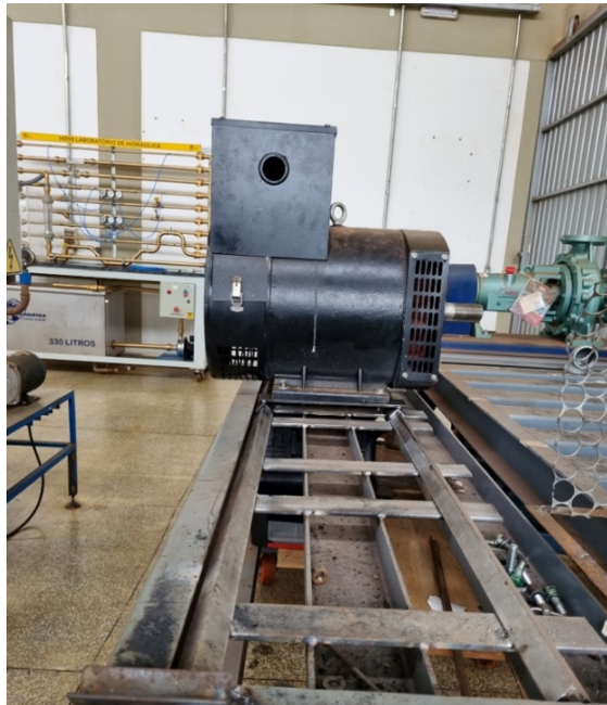
Figura 22 – Sistema de deslocamento do alternador instalado na bancada experimental.
