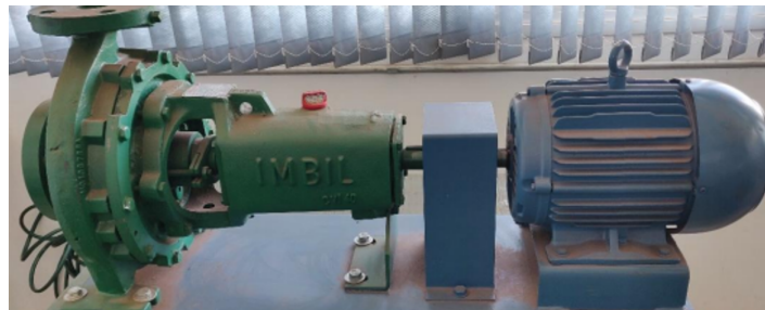
Figura 12 – BFT IMBIL® modelo INI 40250, com potência nominal de 6 cv.
