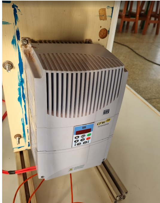
Figura 13 – Inversor de frequência WEG modelo CFW08 utilizado no acionamento da BFB.
