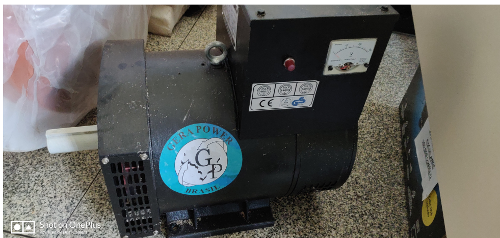
Figura 14 – Alternador síncrono trifásico utilizado no sistema de conversão eletromecânica.
