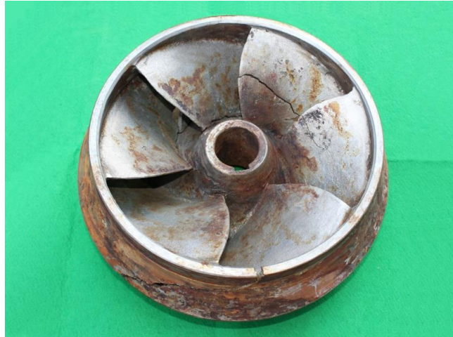
Figura 5 – Exemplo de rotor de bomba danificada com rachaduras devido a cavitação.
