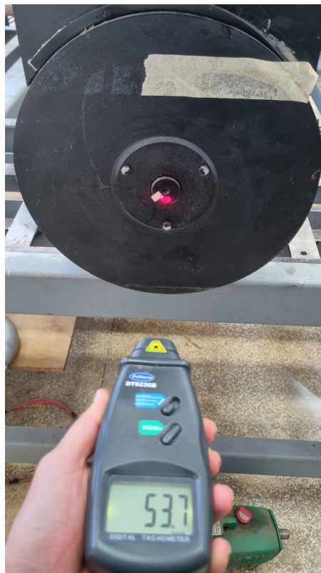
Figura 53 – Medição da rotação do conjunto BFT-alternador com tacômetro óptico e fita refletiva fixada no eixo do alternador.
