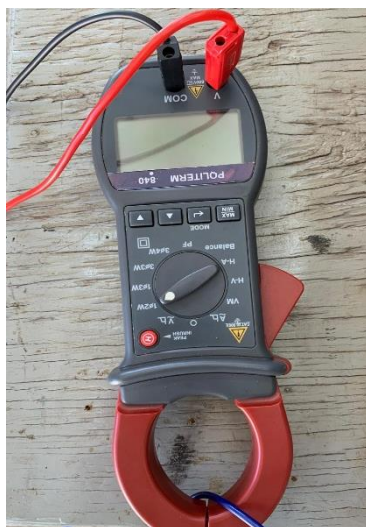
Figura 5 - Alicate amperímetro utilizado no monitoramento elétrico (Fonte: Autores).
