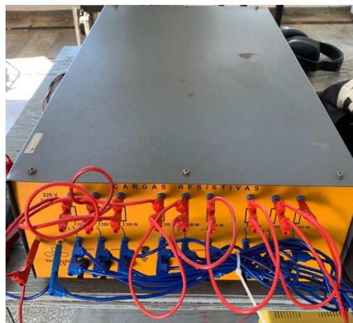
Figura 4 – Banco de cargas resistivas (Fonte: Autores).
