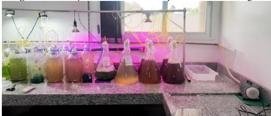
Fotografia 2 – Aeração de bancada com compressor de ar eletromagnético
