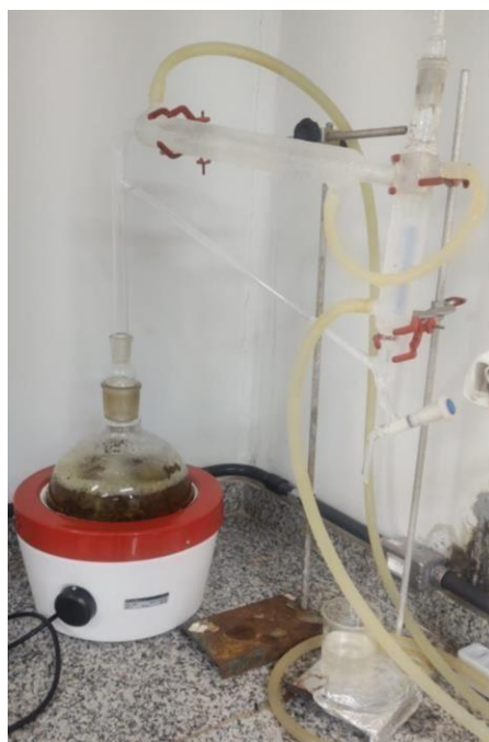
Figura 4: Extração de óleo essencial no aparelho de Clevenger.
