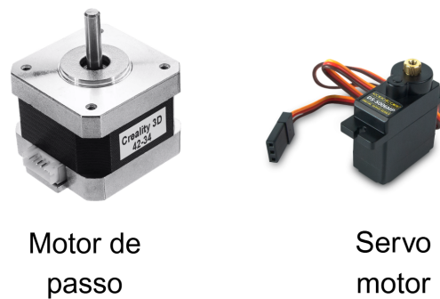
Figura 20 – Representação visual de um servo motor e um motor de passo para aplicações de baixa potência.
