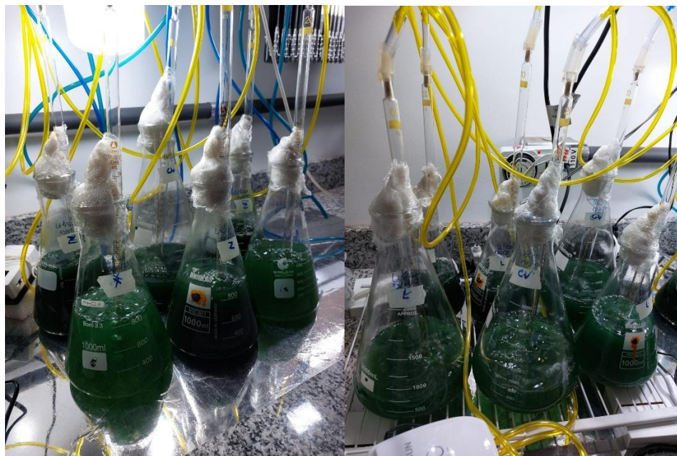
Figura 4. Experimento 2- Cultivo de Limnospira platensis em meio Zarrouk, meio X, meio Lentilha e meio Chá Verde sob bancada do Laboratório de Cultivo de Microrganismos.
