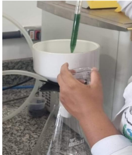
Figura 5. Preparação de amostras coletadas do meio Zarrouk, meio X, meio Lentilha e meio Chá Verde para a realização da análise de peso seco.
