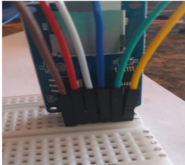
Figura 20 - Conexão dos fios jumper ao módulo microSD.
