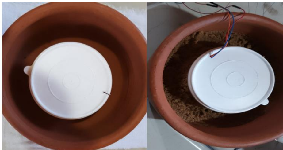
Figura 32 - Montagem do vaso de cerâmica externo e recipiente interno de plástico conectado ao kit Arduino.
