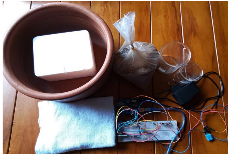
Figura 33 - Montagem do vaso de cerâmica externo e recipiente interno de isopor conectado ao kit de Arduino.
