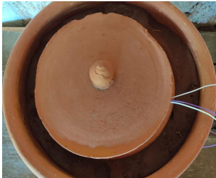
Figura 9 - Vaso interno e externo com areia molhada e sensores instalados.
