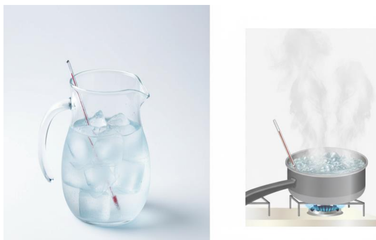
Figura 10 - Termômetro em contato com o gelo e com o vapor.
