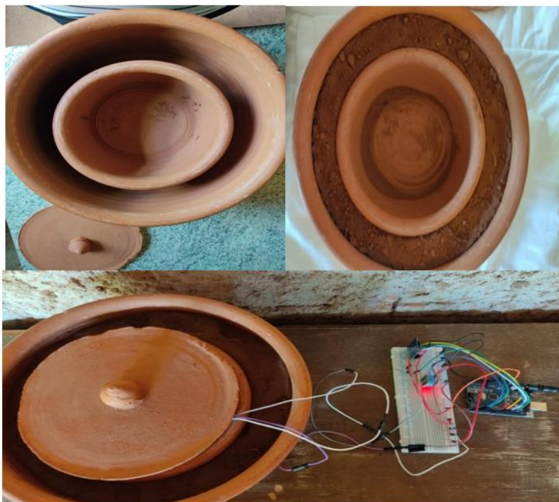
Figura 29 - Vasos de cerâmica externo e interno conectado ao kit Arduino.
