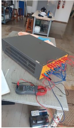
Figura 3- Bancada de resistores
