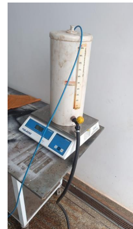
Figura 2 – Reservatório de combustível e balança de precisão
