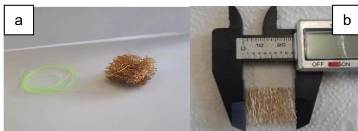
Figura 5. – Amostra de adsorventes de LC in natura fixados em uma linha (a), amostra de adsorventes de LC in natura medida do adsorvente utilizando um paquímetro (20 a 23 mm) (b).
