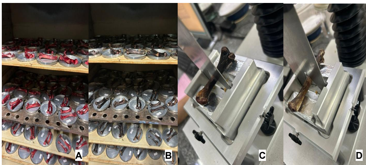
Figura 13: Análise de resistência óssea em frangos de corte. (A) Amostras na estufa para secagem (B) Amostras depois de 24 horas dentro da estufa (C) Fêmur na shear force (D) Tíbia na shear force.
